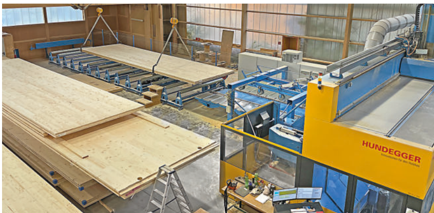
Elemente mit Maßen bis zu 3,6 mal 16,5 m und Stärken bis 40 cm können auf der PBA-Drive bearbeitet werden
