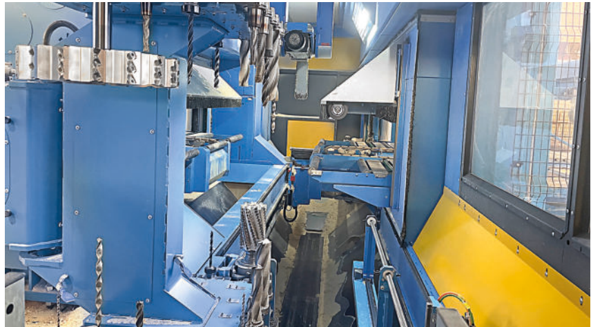
26 Werkzeugen bietet das Werkzeugmagazin Platz. Darüber hinaus verfügt die Maschine über Spezialwerkzeuge wie Kettenfräser oder zwei Tiefloch-Bohraggregate
