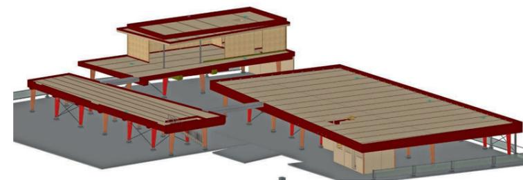
↑ Die 3D-CAD-Isometrie zeigt den Holz-Rohbau der aufgeständerten Plattformen. Nur die Insel für den Meeting Point erhielt einen zusätzlichen Aufbau für den öffentlichen Besprechungsraum. Foto: ABA Holz van Kempen
