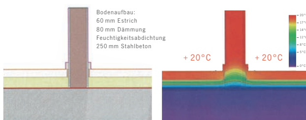
Abb. 3: Isothermenverlauf bei KLH-Wand auf Beton-Bodenplatte bei gleichzeitiger Innendämmung. Klar zu erkennen ist, dass die KLH-Platte von den 10°- und 12°-Isothermen geschnitten wird (Schimmelpilz- und Tauwasser-Isothermengrenze)
