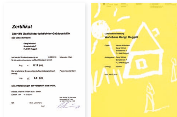
Abb. 9: Ein Blower-Door-Test in einem Passivhaus gebaut mit KLH-Massivholzplatten. Mit Hilfe eines hervorragenden Luftdichtheitskonzeptes konnte ein n 50 -Wert von 0,15 h -1 realisiert werden [mit freundlicher Unterstützung durch Eberle • d e n k f a b r i k • Dornbirn, Österreich]
